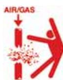
NE JAMAIS utiliser d'air ou de gaz comprimés dans des tuyaux et raccords en PVC/PVCC.
